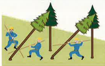
(図2)かかり木の処理
